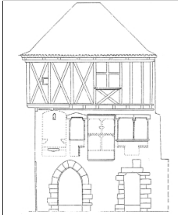
Fig. 32. PLACARD EN ENCORBELLEMENT SUR LA FAÇADE d'une maison de Saint-Cirq-Lapopie (XIV e siècle). Relevé V. Rousset.
