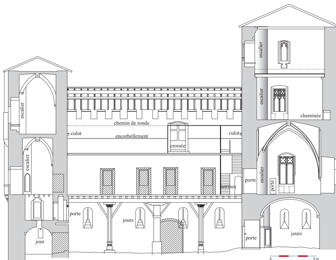
FIG. 15. COUPE LONGITUDINALE, façades ouest. Relevé C. Viers.
