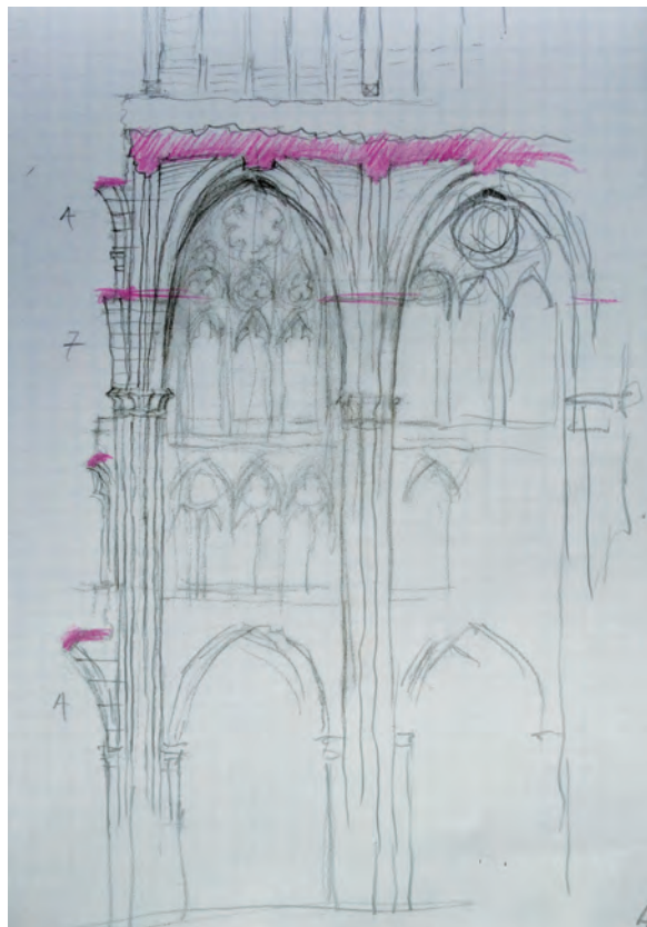
FIG. 28. BAYONNE, CATHÉDRALE, élévation intérieure d'une travée de la nef : sont colorées en magenta les arases supérieures des tas de charge aux quatre niveaux, croquis de travail. Dessin et cliché B. Sournia.
