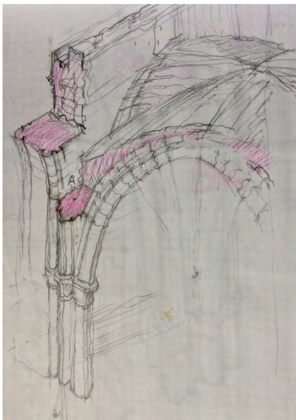
FIG. 27. BAYONNE, CATHÉDRALE, croquis de travail d'un tas de charge de voûte : en A, assise en attente d'une nervure à construire. Dessin et cliché B. Sournia.
