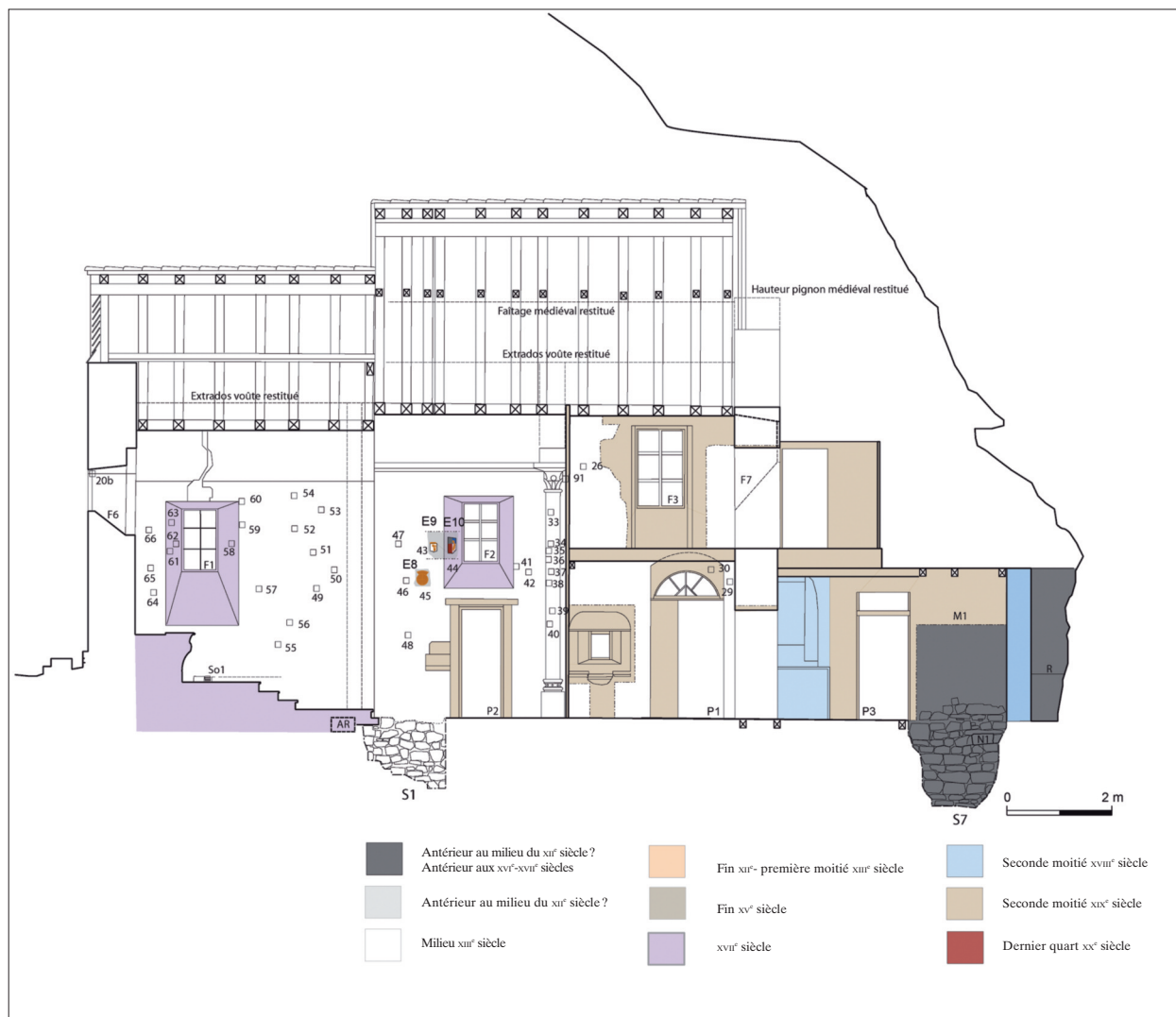
FIG. 7. GLUGES, ÉGLISE ET PRESBYTÈRE (COUPE LONGITUDINALE VERS LE SUD). Relevé et DAO Valérie Rousset, 2007.
