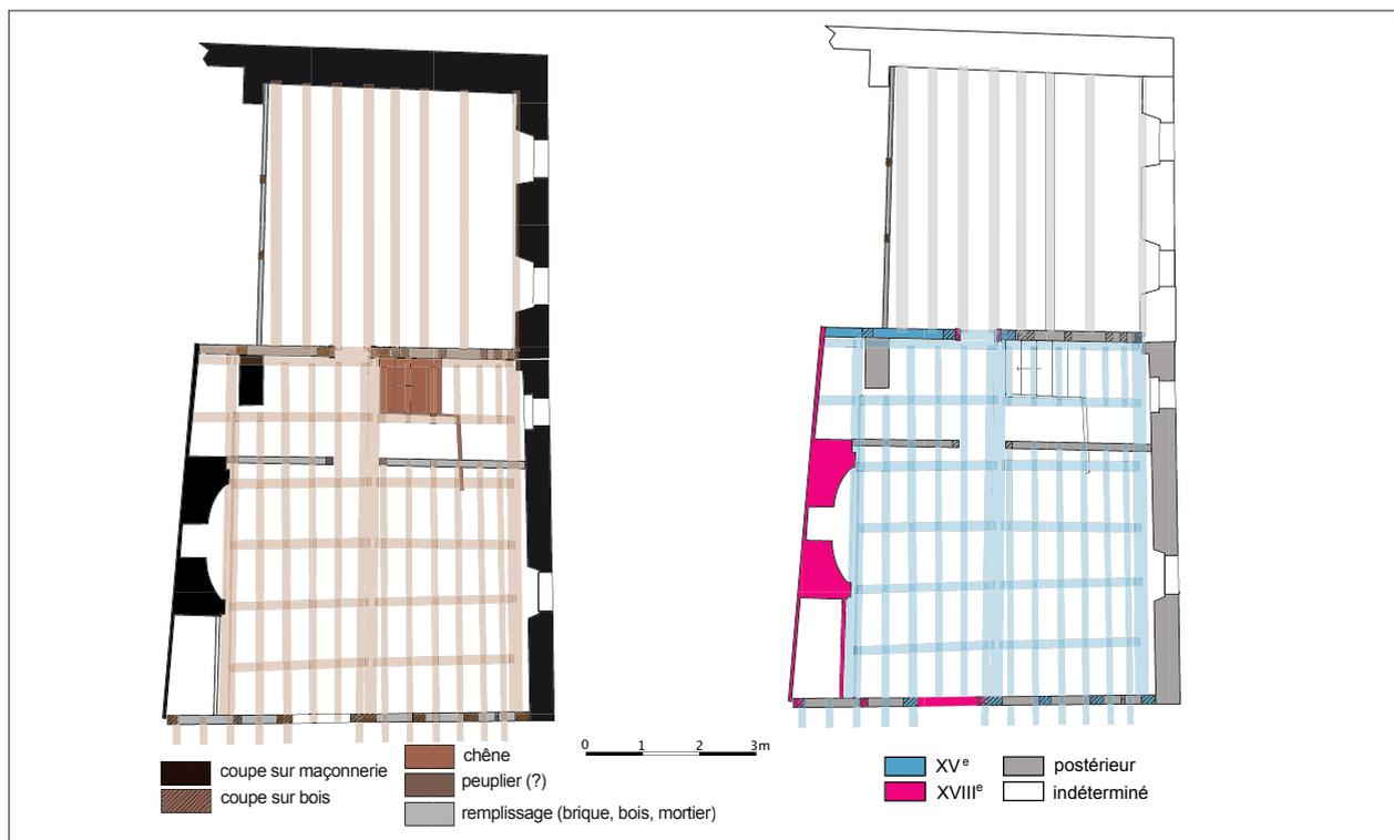
FIG. 15. MAISON DE LA RUE DES NOBLES, plans du premier étage avec projection de la poutraison du plafond : matériaux et principales phases de construction. DAO, A.-L. Napoléone.
