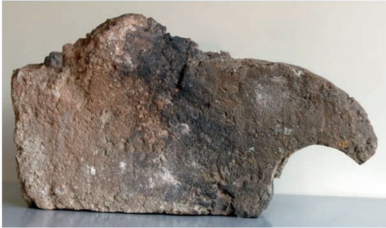
CAUSSADE (TARN-ET-GARONNE), Tour d'Arles : brique d'une archivolte de fenêtre. Cl. M. Scellès.
