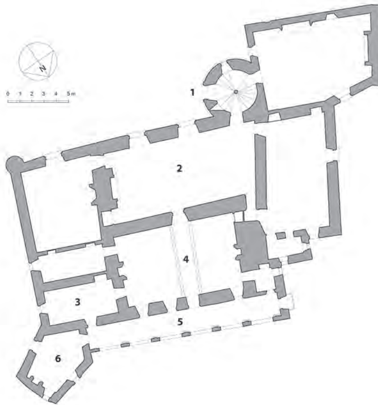
FIG. 4. BRUNIQUÉL, PLAN DU CHÂTEAU-VIEUX AU REZ-DE-CHAUSSÉE. 1 : porte de la tour d'escalier accostée d'une bouche à feu. 2 : grande salle du rez-de-chaussée. 3 : ancienne chapelle Sainte-Anne. 4 : couloir central d'accès à la galerie. 5 : galerie Renaissance. 6 : tour du XVI e siècle, solidaire de la galerie. Plan et DAO G. Séraphin d'après relevés Covalence.
